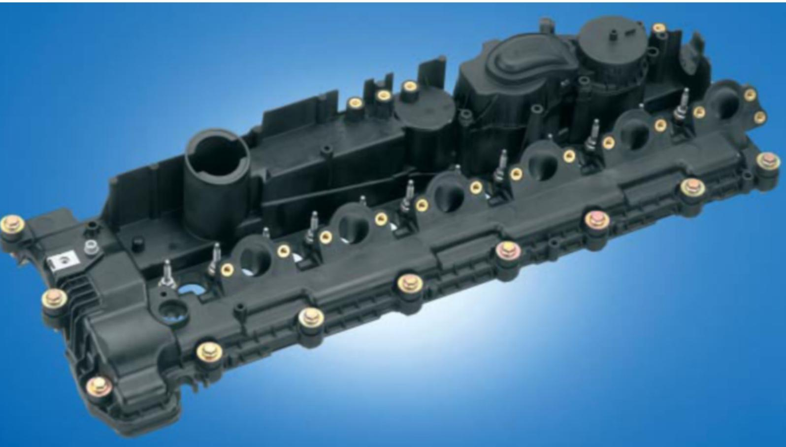
Zylinderkopfhauben aus Kunststoff erobern zunehmend auch die Bereiche der Hochleistungsmotoren. Dass die hohe Leistungsdichte eines modernen Motors – wie des Sechszylinder-Dieselmotors mit Stufenaufladung von BMW – den Einsatz von Kunststoffhauben nicht ausschließt, zeigt dieser Beitrag. Die Polyamid-Haube mit integrierter Blow-by-Ölabscheidung ist eine gemeinsame Entwicklung des Systemlieferanten Robert Bosch GmbH und der BMW AG.
