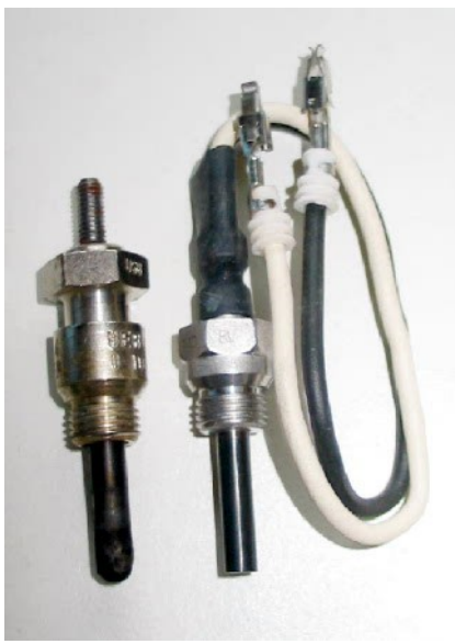
Hier links die Standardglühkerze, rechts die keramische
